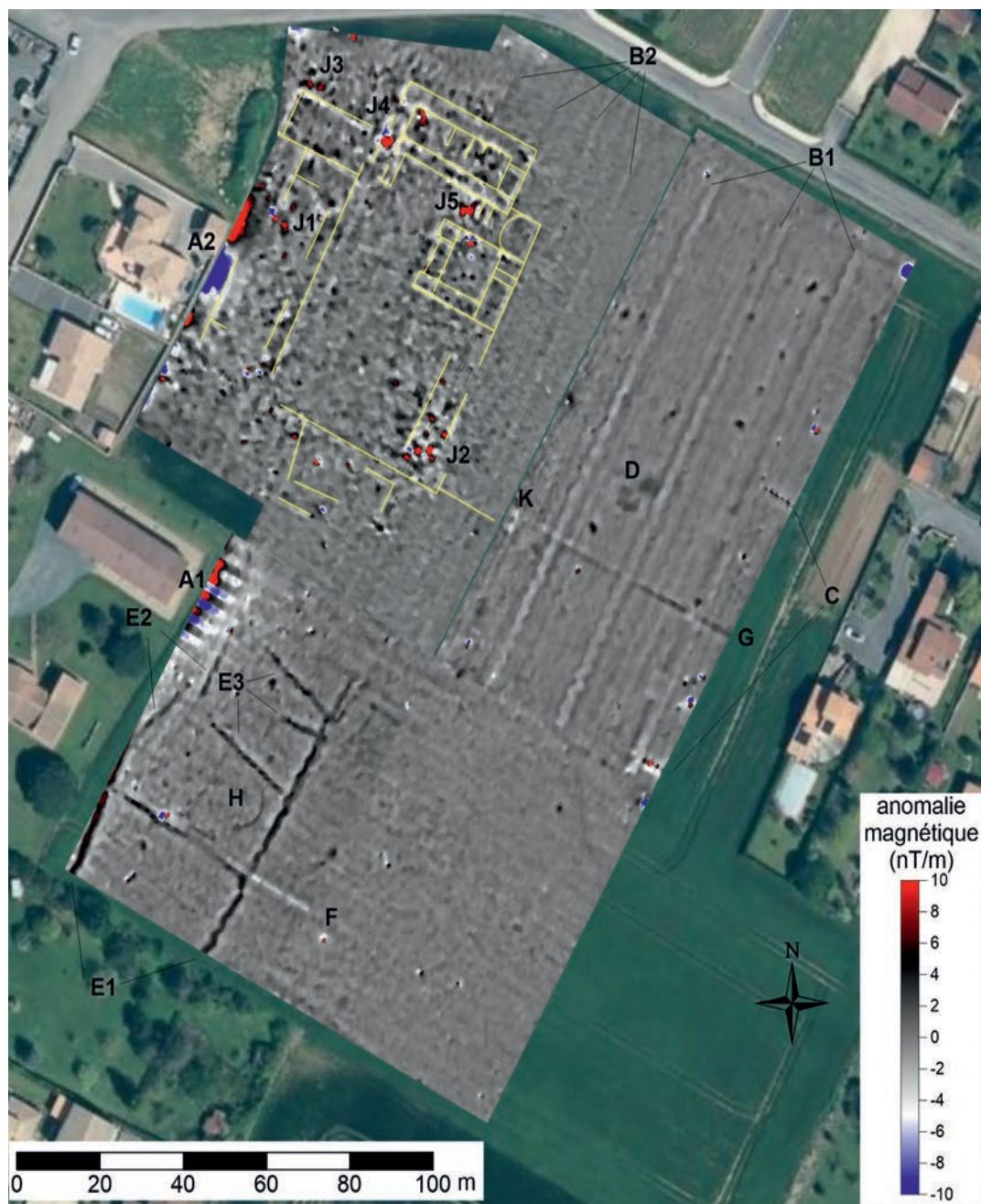
Fig. 49. Relevé des principales anomalies magnétiques sur la carte positionnée sur une orthophotographie d'avril 2018 (Géoportail, IGN). Les anomalies magnétiques discutées dans le texte sont notées en gras (A1 à K) ou soulignées par des traits jaunes (DAO V. Mathé).
