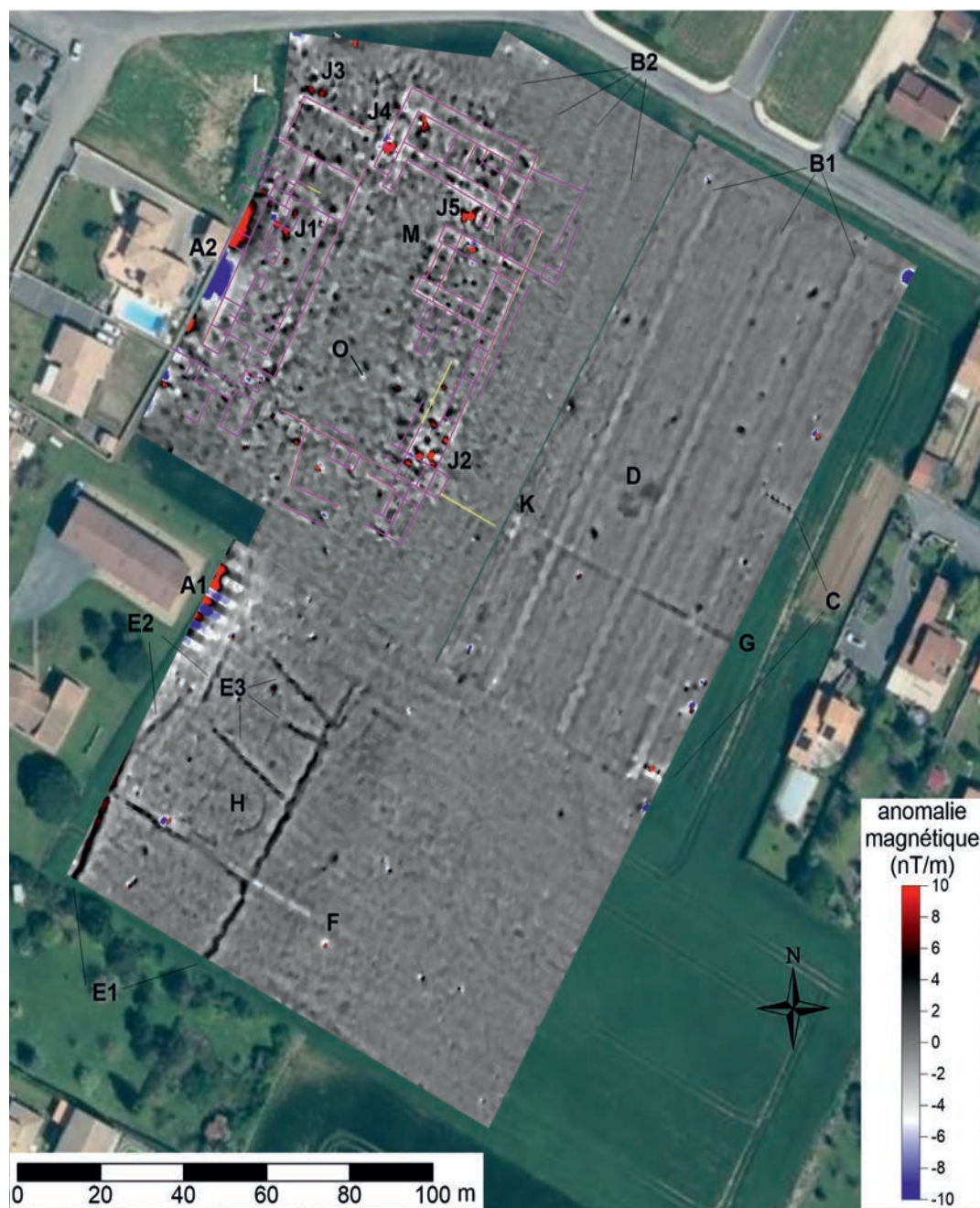
Fig. 53. Relevé des principales anomalies de résistivité (traits violets) positionnées sur la carte d'anomalies magnétiques. Fond : orthophotographie d'avril 2018 (Géoportail, IGN) (DAO V. Mathé).
